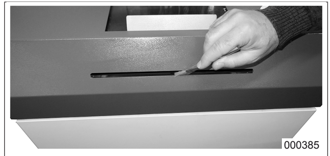
Abb. 11 Reinigung der Fotozellen
