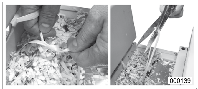
fig. 16 Ficelage de la balle
