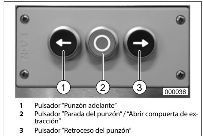
fig. 12 Elementos de manejo compactador
